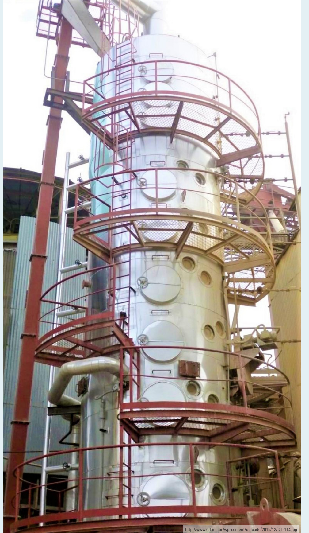
Bitkisel yağ üretiminde kullanılan desolventizer-tost (toaster) makinesi
